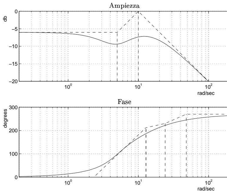
Figura 2: Diagrammi di Bode delle ampiezze e delle fasi della funzione  $G(s)$ .
