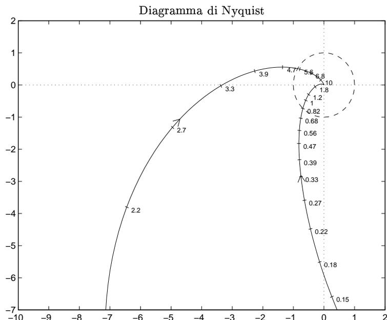
Figura 5: Diagrammi di Nyquist della funzione  $G_f(s)$  e del corrispondente sistema con rete ritardatrice.
