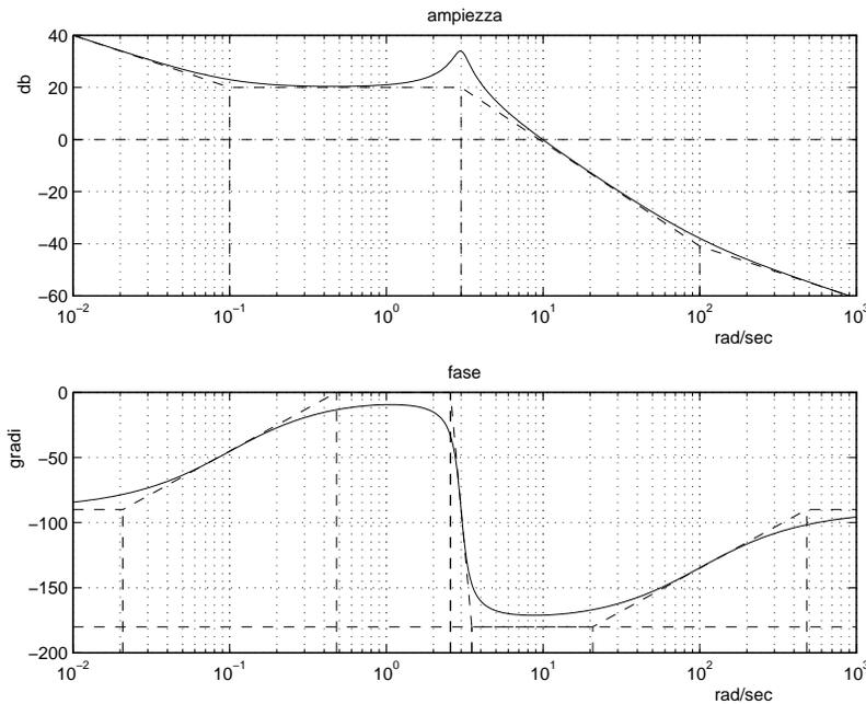
Figura 1: Diagrammi asintotici di Bode della funzione  $G(s)$
