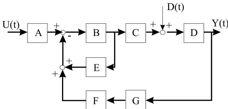
Calcolare (a) lo schema ridotto fra U e Y, (b) lo schema ridotto tra D e Y.
