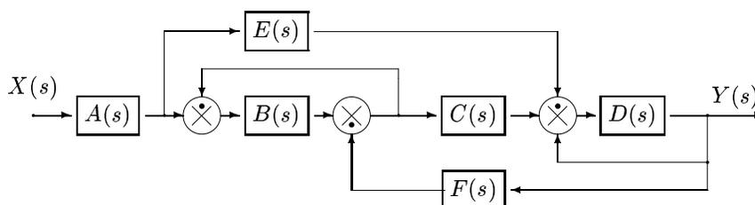
d) Tracciare i diagrammi asintotici di Bode delle ampiezze e delle fasi della seguente funzione di trasferimento:
