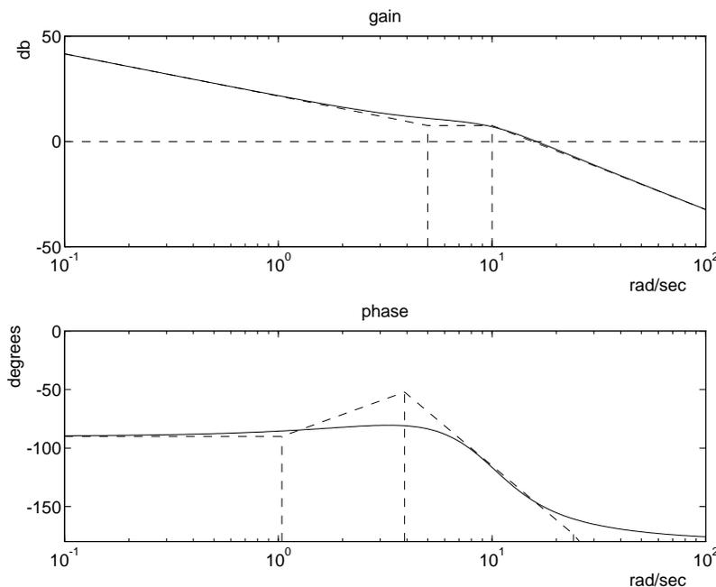
Figura 5: Diagrammi asintotici di Bode del guadagno di anello  $G(s)H(s)$
