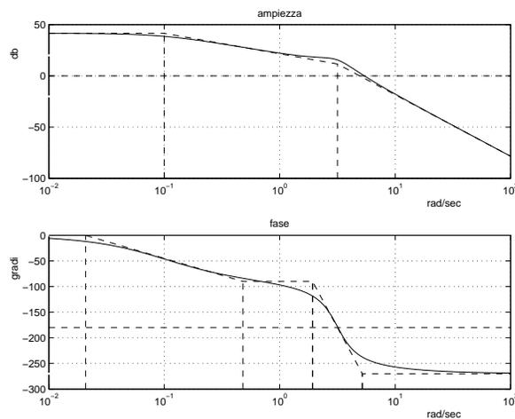
Figura 2: Diagrammi asintotici di Bode del guadagno di anello  $G(s)H(s)$
