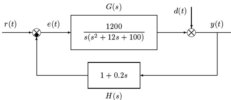
Tracciare i diagrammi di Bode delle ampiezze e delle fasi del guadagno di anello  $G(s)H(s)$ . E' sufficiente tracciare le approssimazioni asintotiche a spezzata.
