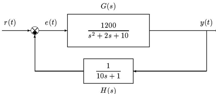
1) Tracciare i diagrammi di Bode delle ampiezze e delle fasi del guadagno di anello  $G(s)H(s)$ . E' sufficiente tracciare le approssimazioni asintotiche a spezzata.
