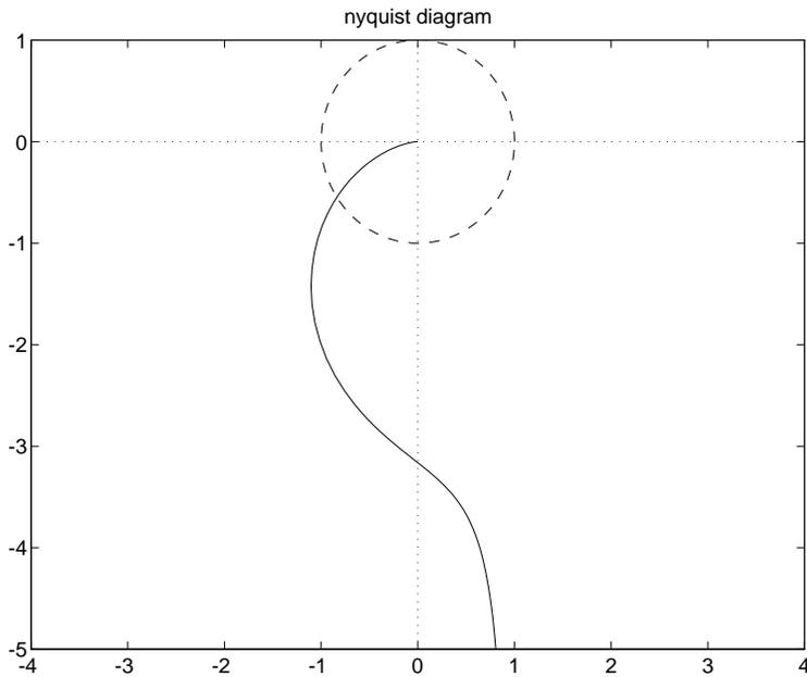
Figura 6: Diagramma di Nyquist del guadagno di anello  $G(s)H(s)$
