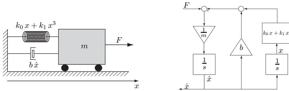
in cui  $u = F$  rappresenta l'ingresso del sistema,  $y = \dot{x}$  l'uscita e i parametri valgono  $m = 1$  Kg,  $k_0 = 0.5$  N/m,  $k_1 = 0.25$  N/m<sup>3</sup>,  $b = 0.75$  M/s/m:
