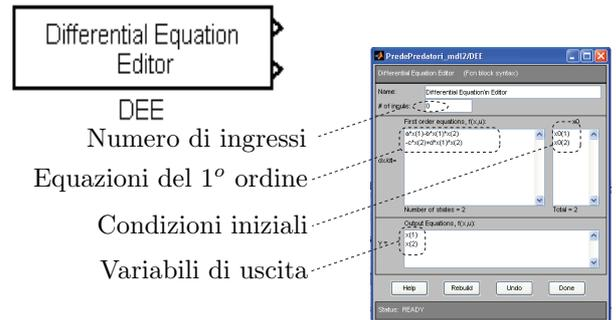
blocchetti simulink per la definizione di ingressi e uscite di interesse (che quindi si rifletteranno sulle matrici  $B$  e  $C$  del sistema linearizzato):
