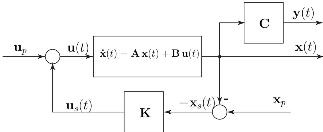
mette in evidenza lo stato “desiderato”  $\mathbf{x}_p$ . In generale esso non è dato, ma viene fornito il vettore  $\mathbf{y}_p$ . E' perciò conveniente calcolare il segnale di controllo  $\mathbf{u}(t) = -\mathbf{K}\mathbf{x}(t) + \mathbf{u}_{ps}$ , definendo  $\mathbf{u}_{ps}$  sulla base del set-point  $\mathbf{y}_p$ .
