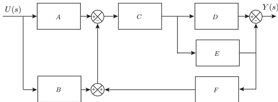
utilizzando la formula di Mason calcolare la funzione di trasferimento  $G(s)$  che lega l'ingresso  $U(s)$  all'uscita  $Y(s)$ .
