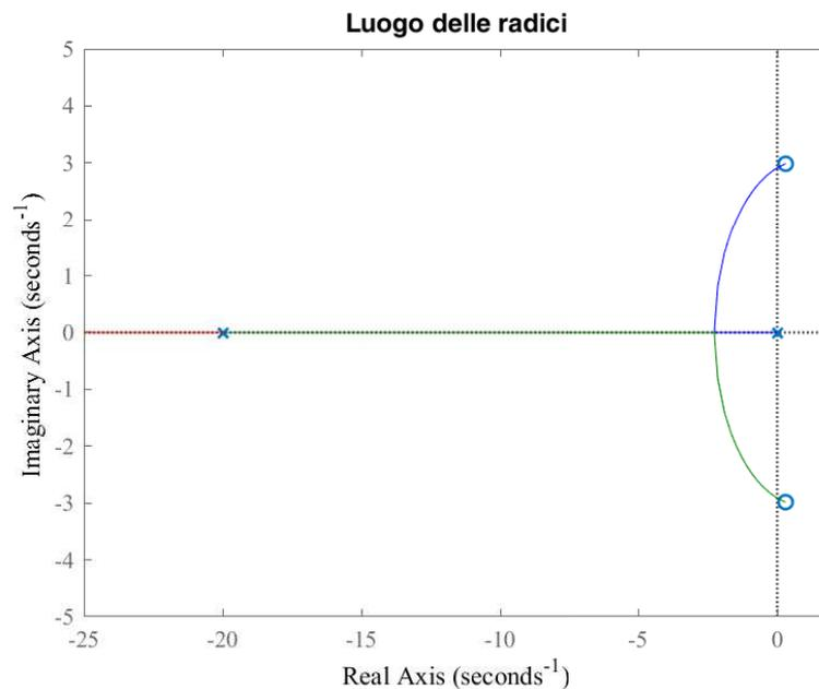
Dall'analisi svolta mediante il criterio di Routh, risulta che il luogo delle radici attraversa l'asse immaginario in corrispondenza di  $\pm j\omega^* = \pm j2.9121$  per  $K = K^* = 65.2533$ .
