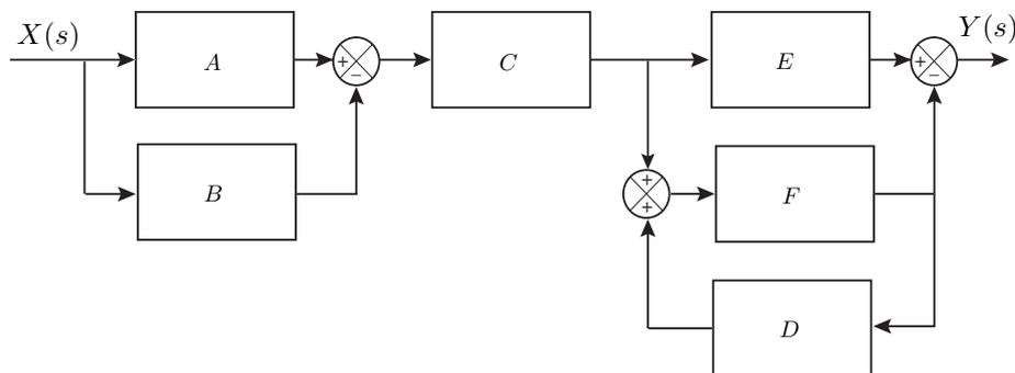
utilizzando la formula di Mason calcolare la funzione di trasferimento  $G(s)$  che lega l'ingresso  $X(s)$  all'uscita  $Y(s)$ .
