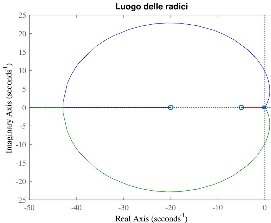
Dall'analisi svolta mediante il criterio di Routh, risulta che il luogo delle radici attraversa l'asse immaginario in corrispondenza di  $\pm j\omega^* = \pm j9.75$  per  $K = K^* = 3.8$ .
