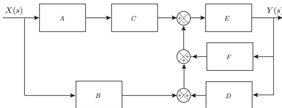
utilizzando la formula di Mason calcolare la funzione di trasferimento  $G(s)$  che lega l'ingresso  $X(s)$  all'uscita  $Y(s)$ .
