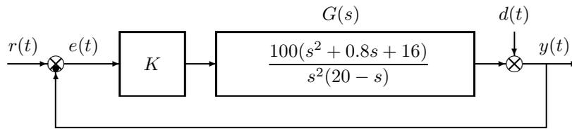
e.1) Determinare per quali valori del parametro  $K$  il sistema retroazionato è asintoticamente stabile.
