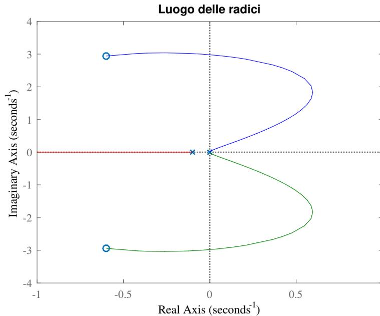
Dall'analisi svolta mediante il criterio di Routh, risulta che il luogo delle radici attraversa l'asse immaginario in corrispondenza di  $\pm j\omega^* = \pm j2.98$  per  $K = K^* = 7.4$ .
