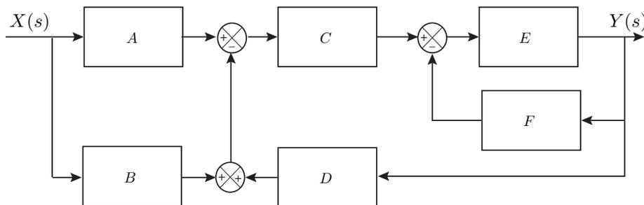
utilizzando la formula di Mason calcolare la funzione di trasferimento  $G(s)$  che lega l'ingresso  $X(s)$  all'uscita  $Y(s)$ .
